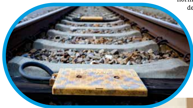
Zařízení Eurobalise na trati s ETCS
