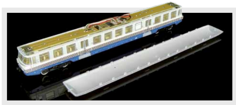
Do útrobu se lze dostat pouhým sejmutím střechy, kterou drží čtyřadvacet zámečků, dvanáct po každé straně.
