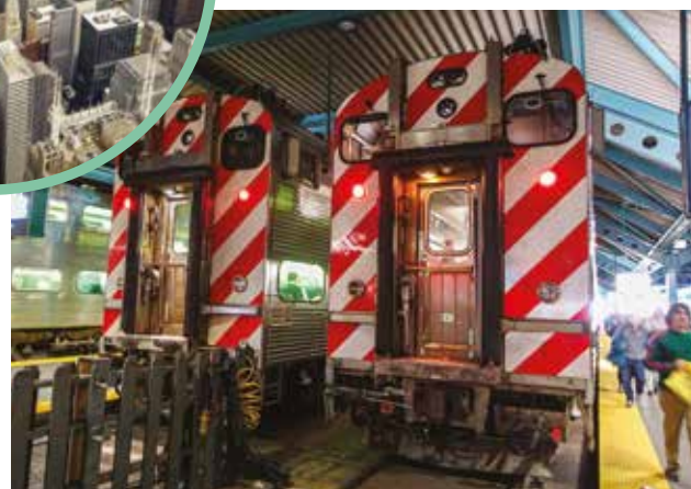
Příměstské vlaky v okolí Chicaga používají řídicí vozy. Jsou plně průchozí a strojvedoucí sedí vlevo nahoře.
