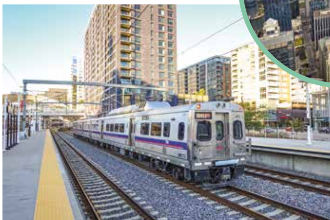
Příměstskou dopravu v okolí Denveru zajišťují elektrické jednotky od korejské Hyundai Rotem typicky amerického nerezového vzhledu.
