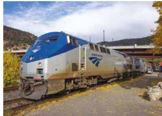
Vlak Caliphornia Zephyr právě zastavil ve stanici Glenwood Springs. Lokomotivám typu Genesis P42DC po celou cestu nepřestávají běžet motory o úctyhodném výkonu 3 170 kW.
