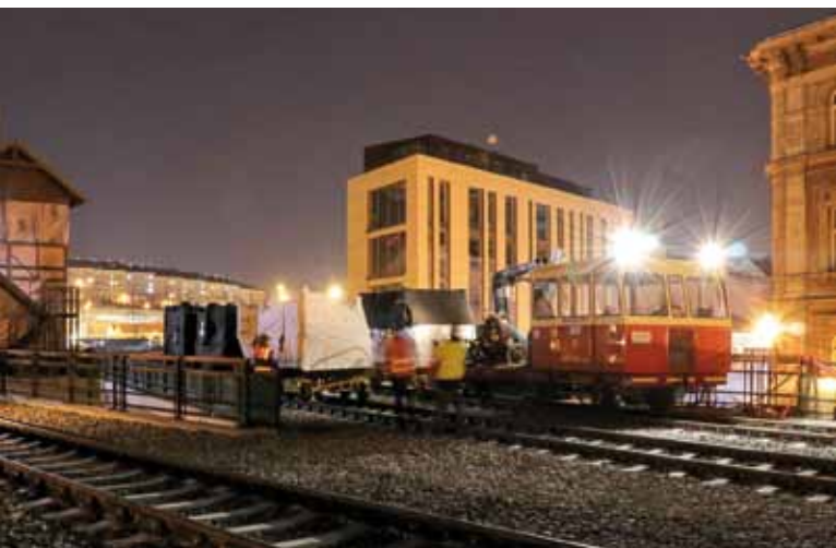
Vozíky se závažím během nočního testování 27. března
