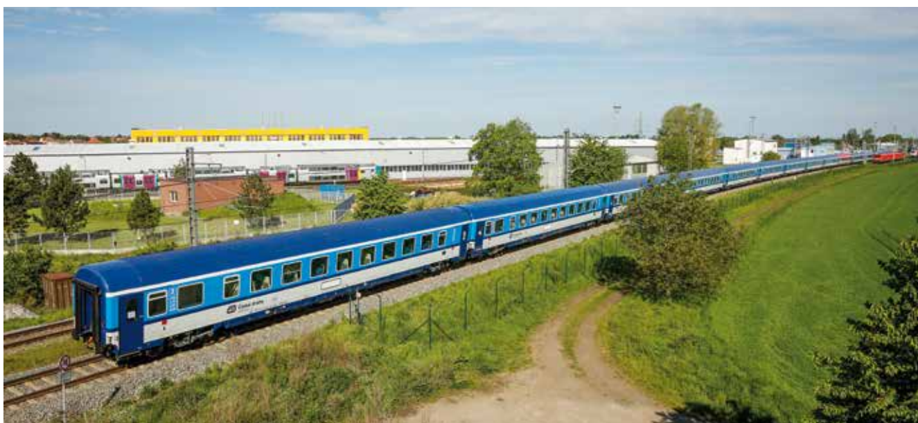
V květnu 2016 se na okruhu ve Velimě uskutečnily jízdní brzdové zkoušky s vozy Bmz při rychlosti 200 km/h. Jejich cílem bylo stanovení brzdícího účinku vozů po modernizaci. Soupravu o délce 400 m tvořilo 15 modernizovaných vozů ČD řady Bmz tažených elektrickou lokomotivou ČD řady 380.
