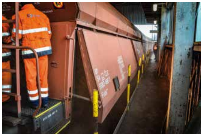
Vykládka vozů řady Falls na hlubinném zásobníku v teplárně Krnov
