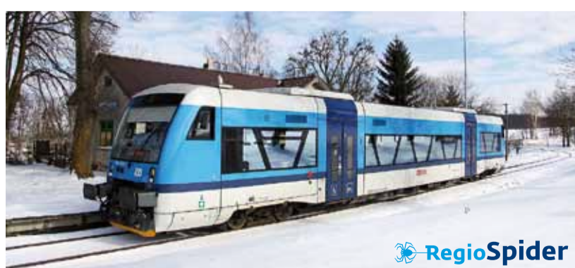
DRAVEC. Vozy využívají výkonu 530 kW a pohonu na oba podvozky. FOTO AUTOR
