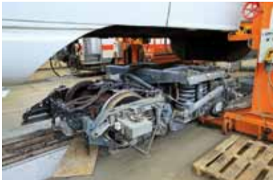
Stopku provozu vlaků ICE-T vystavily nebezpečné trhliny na nápravě. FOTO DB
