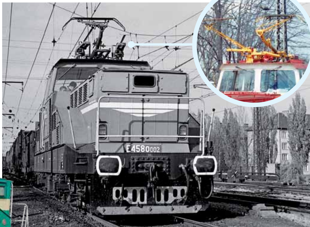
Žehlička E458.0002 vybavená kromě hlavního ještě i dvěma pomocnými sběrači pro napájení z pomocné troleje na 1. posunu ve Valašském Meziříčí v roce 1971. Foto Evžen Stříbrnský, sbírka Jan Novotný
