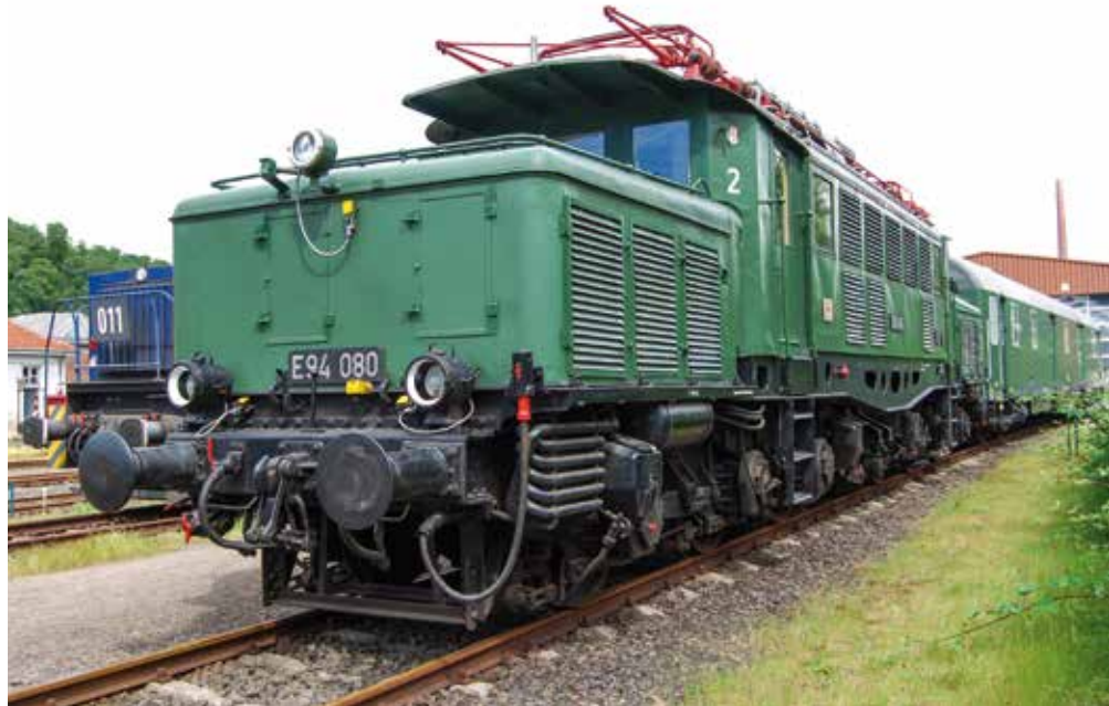
Navzdory kapotám byly řady E 93 a E 94 ve srovnání s předchozími šestinápravovými lokomotivami se spojnicemi a jalovými hřídeli moderně řešené stroje. V provozu se udržely až do 90. let
