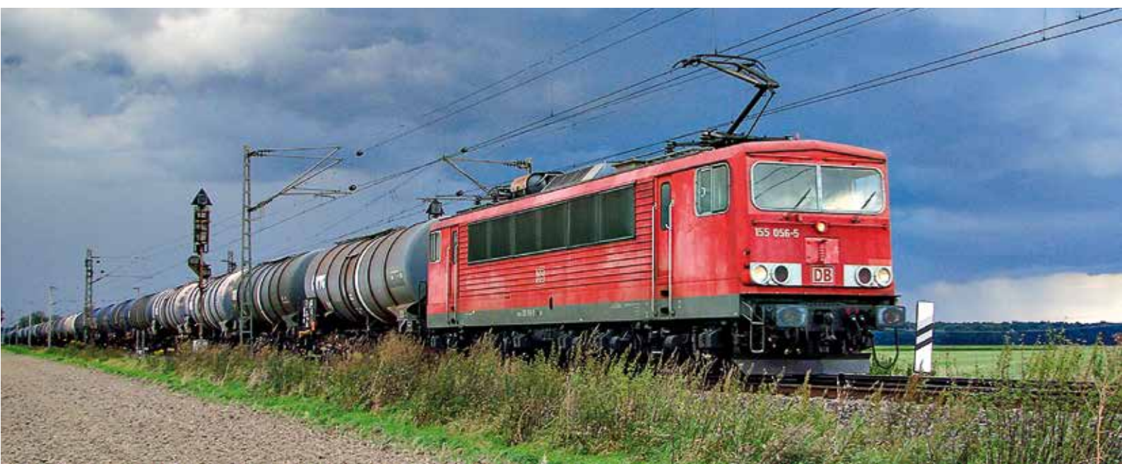
DR zavedla na běžné síti moderní šestinápravové elektrické lokomotivy řady 250 až na přelomu 70. a 80. let. Po sjednocení Německa se jako řada 155 osvědčily v čele těžkých nákladních vlaků od Alp po Severní a Baltské moře
