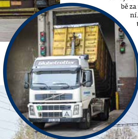
Překládka kontejnerů z železničního vozu na automobil je velice jednoduchá.
