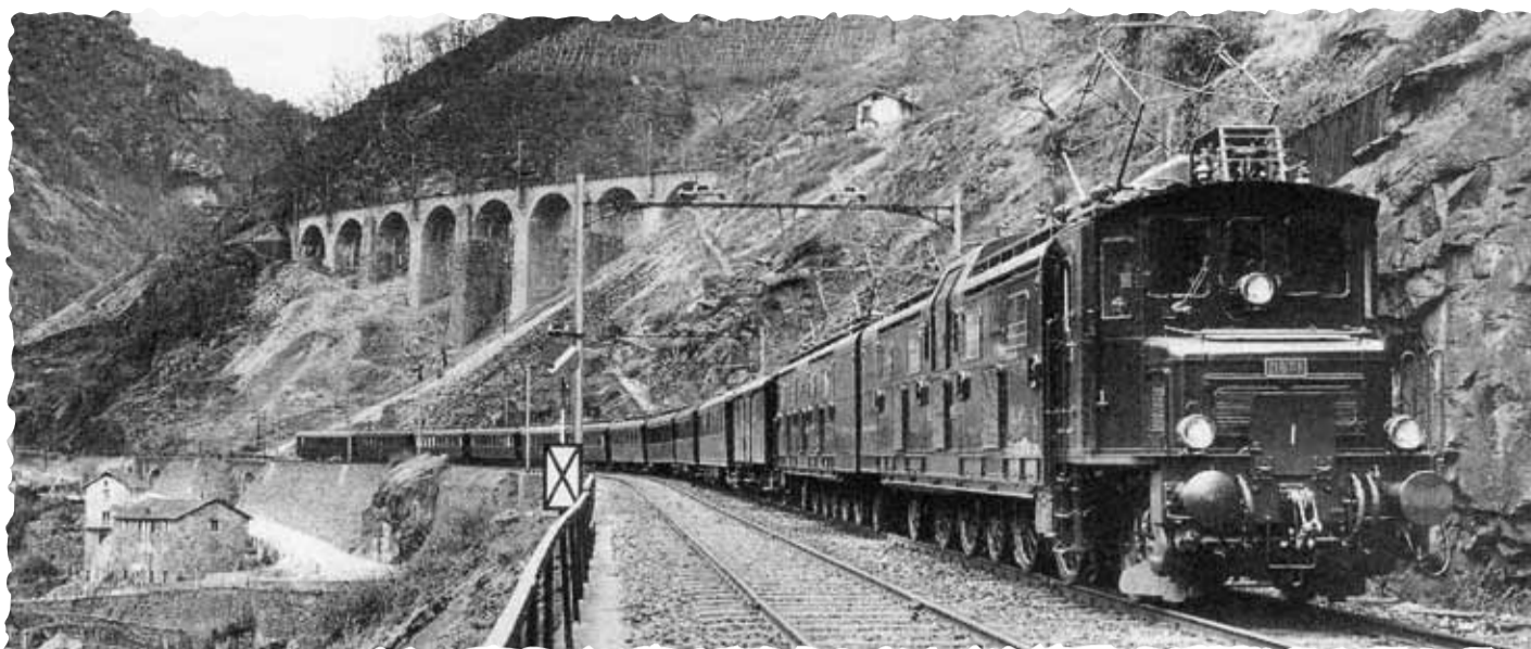
ROK 1932. U hradla Pianotondo na jižní rampě Gotthardské dráhy zastavil fotovlak vedený novou lokomotivou Ae 8/14 11851. FOTO MF OERLIKON
