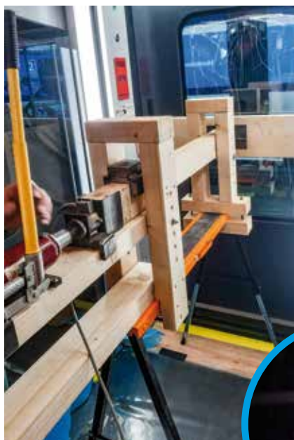
Zkouška náporové síly vyvolané cestujícími
