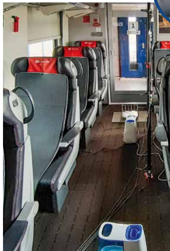
Vůz připravený na zkoušku klimatizace
