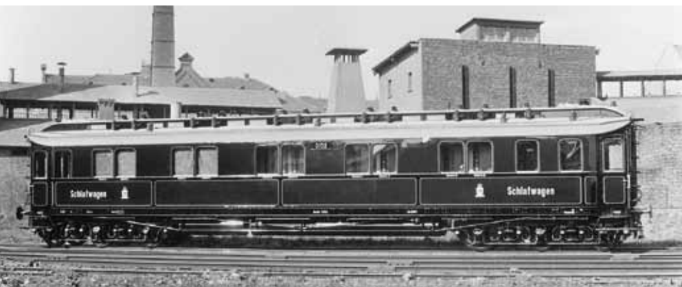
Dobová reliéfy lůžkového vozu ze sbírky DB Museum Nürnberg představuje vůz z přelomu 19. a 20. století. Za pozornost stojí třínápravové podvozky. Ty měly zajistit klidnou jízdu.
