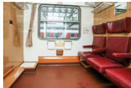
Oddíl pro imobilní cestující ve voze Bbdgmee 236 po rekonstrukci a jeho původní podoba před modernizací v řadě BDmeer
