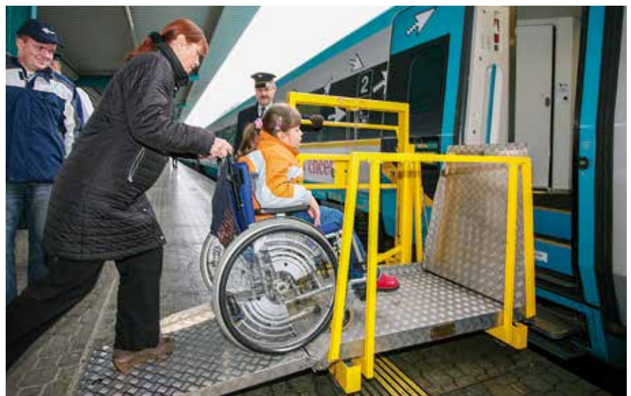
Není-li vůz s oddílem pro imobilní cestující nízkopodlažní a zároveň není vybavený vlastní plošinou, poslouží pro nástup do vlaku staniční plošina.
