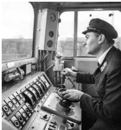
Stanoviště strojvedoucího na V43
