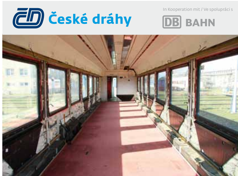
DEMONTÁŽ. Před rekonstrukcí jsou interiéry vagonů kompletně odstrojeny.
