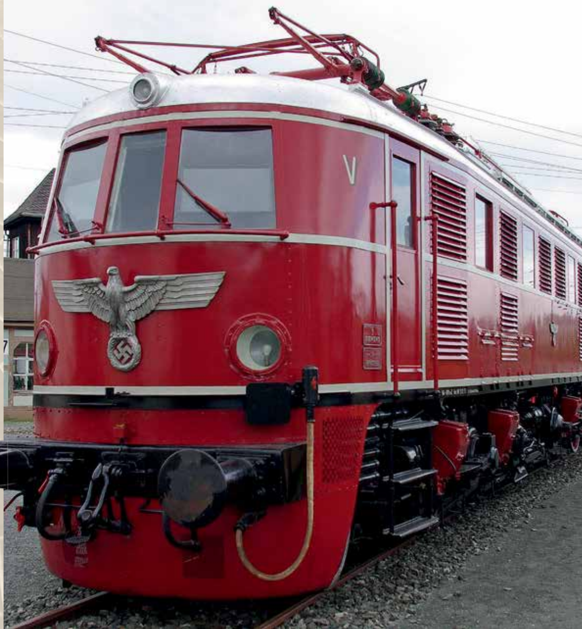
Propagačně nejznámější německá elektrická válečná lokomotiva řady E 19, která dosahovala rychlosti 180 km/h, se stala muzeálním kouskem.
