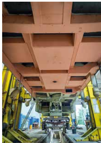
Pohled na zrenovovaný rám lokomotivy
