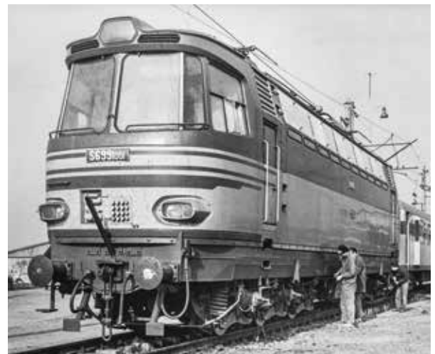
Primárně brzdící lokomotiva S 699.1001, která nahradila původně využívané parní lokomotivy
