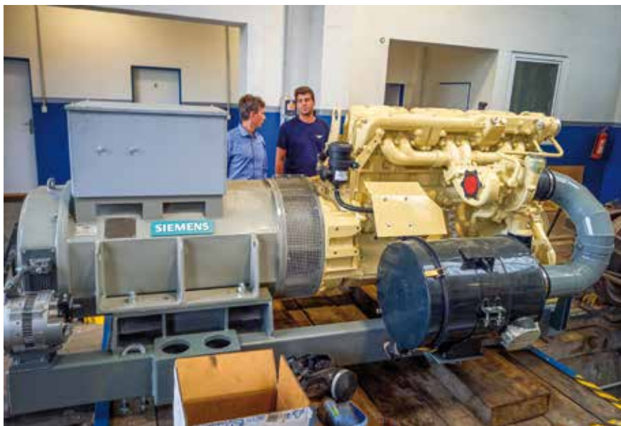
Původní dvanáctiválec ČKD 12V170DR nyní nahradí nový motor TEDOM TD 242 RV TA 25 242
