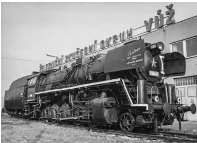
Výkonné parní lokomotivy 556.0 sloužily k simulaci zátěže během zkoušek
