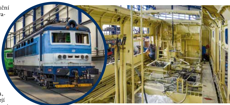
Vyvázaná lokomotiva 242.221 připravená na tryskání a lak (foto vlevo) a útroby 242.212 po lakování ve fázi montáže
