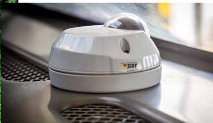
Kamera na stanovišti strojvedoucího u jednotky ř. 680. Postupně by se měla objevit i na dalších hnacích vozidlech pro případné zajištění důkazních materiálů během mimořádných událostí
