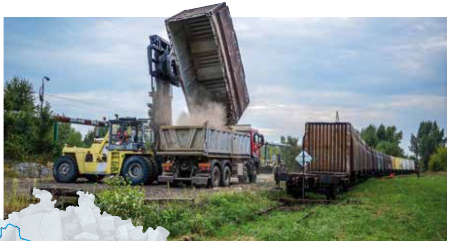
Vykládka nástaveb Innofreight je rychlá a jednoduchá
