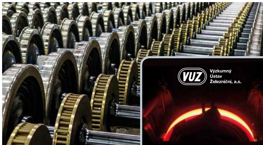
Dvojkolí pro vozy s kotoučovými brzdami tepelně-mechanickou zkoušku kol nepotřebují.
