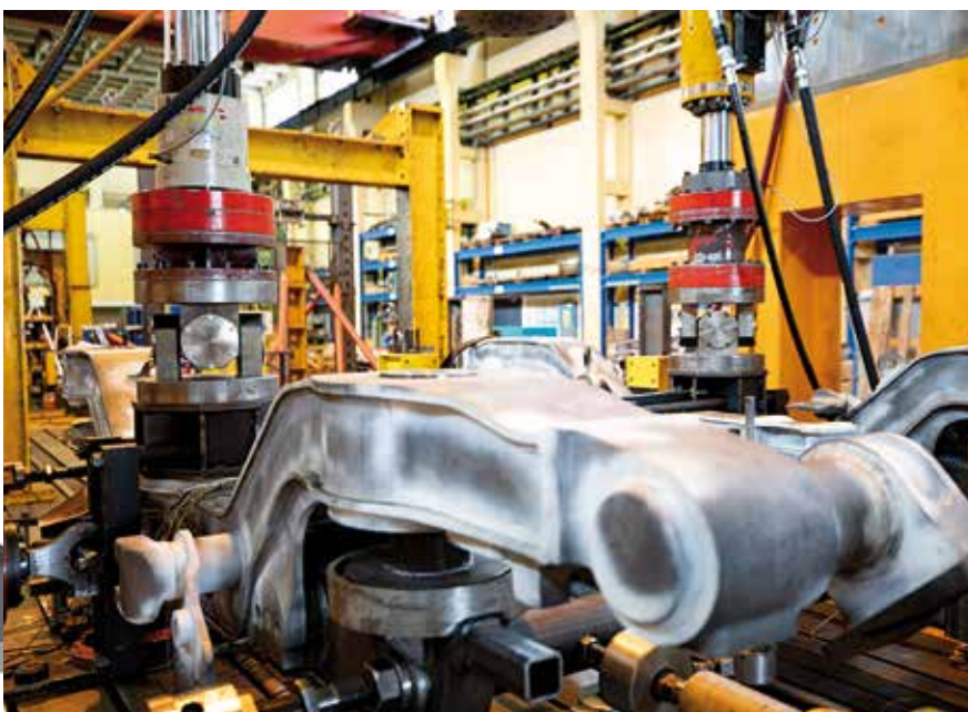
Náhled únavové zkoušky rámu podvozku
