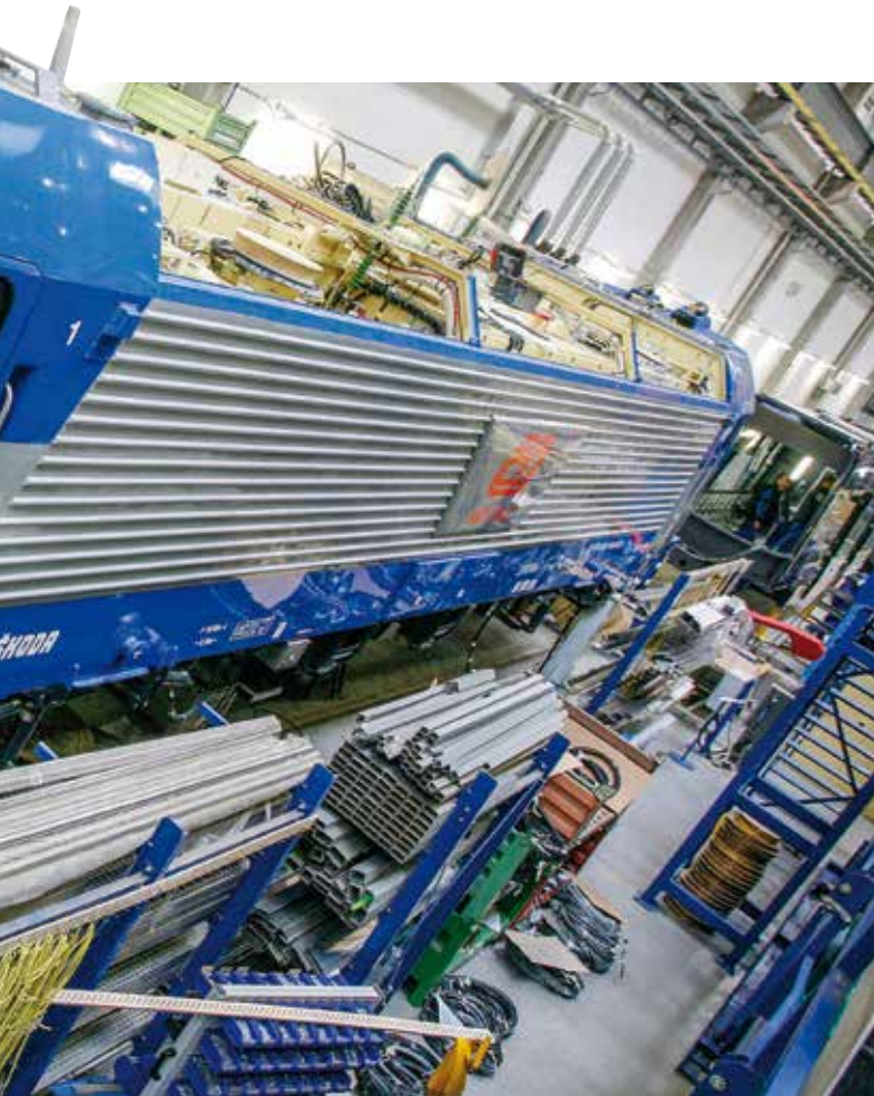
Výroba lokomotivy řady 380 v plzeňské Škodě Transportation
