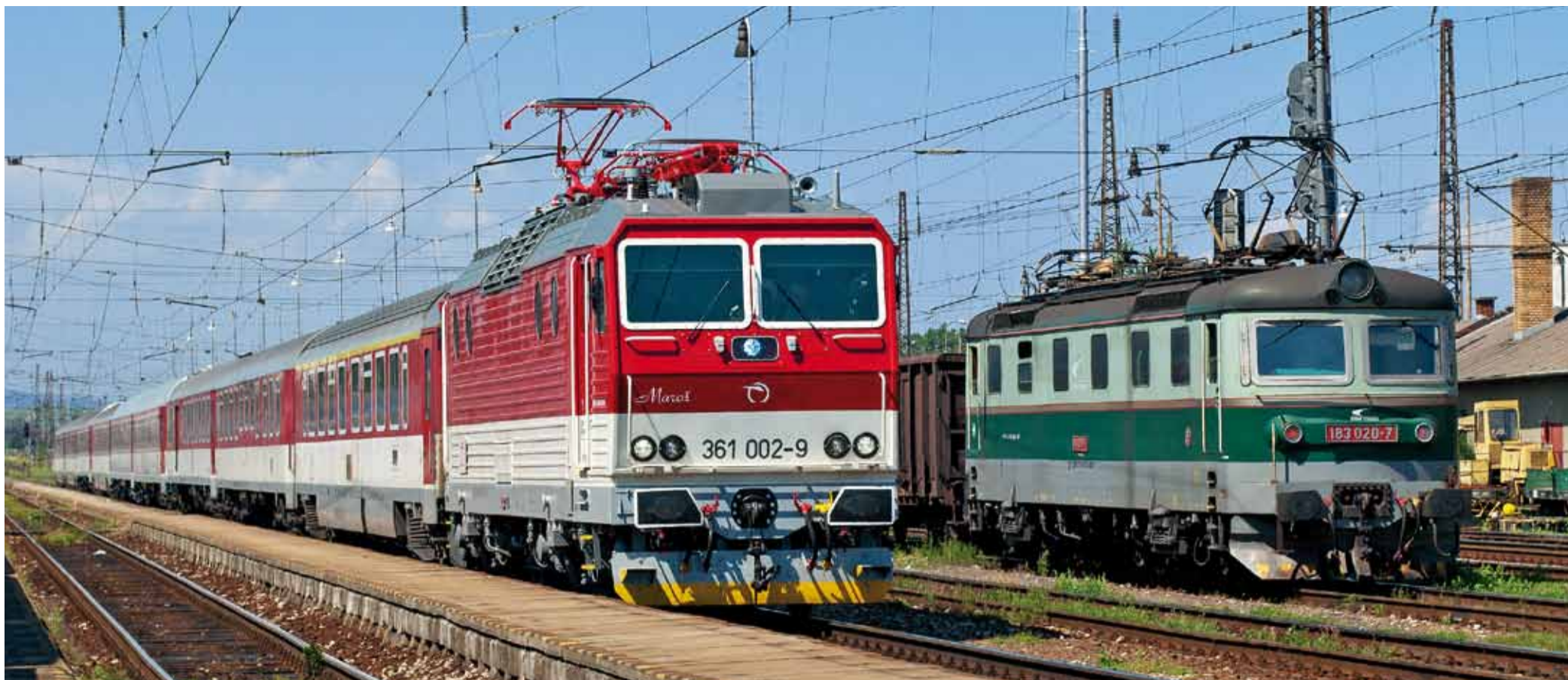
OBOJŽIVELNÍK. Národní dopravec ZSSK se již připravuje na změnu napájecího systému. Stejnosemnné lokomotivy řady 163 modernizuje na dvousystémovou řadu 361.
