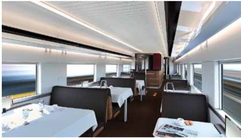
JÍDELNÍ VŮZ. Vnitřní uspořádání celého jedenáctivozového vlaku myslí na bezproblémový pohyb vozičkářů. Chodbičky jsou proto širší. FOTO STADLER RAIL (3x)
