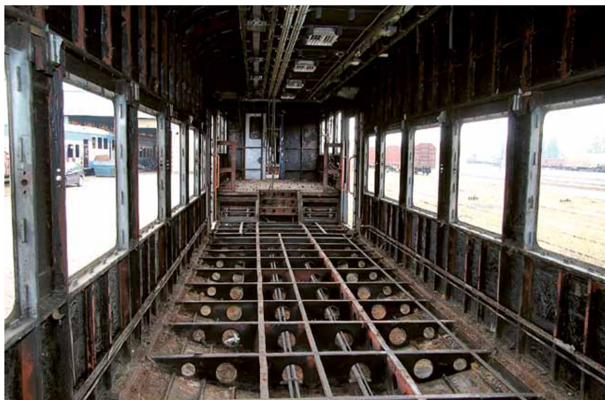
ZBYDE SKELET. Před rozřezáním se vagony musejí kompletně odstrojit. Z interiéru zmizí sedačky, čalounění i podlaha.
