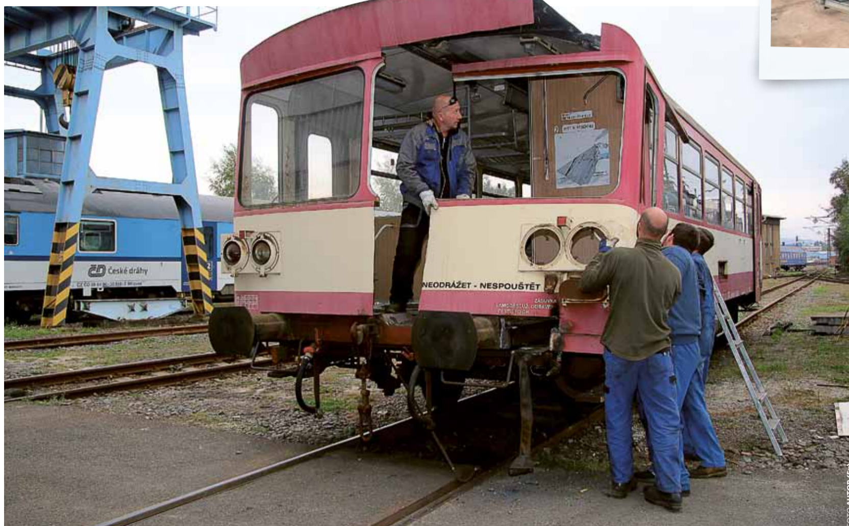
LIKVIDACE. Skelet vozidel se rozstříhá strojními nůžkami a připraví k odvozu do sběrných surovin. Tuto těžkou práci vykonávají speciálně vyškolení zaměstnanci.
