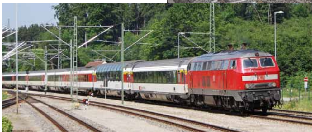
Neobvyklý pohled na EC 191 Basel – Zürich – Lindau – München pouze s jednou lokomotivou řady 218. Pravidelně jsou EC vlaky mezi Mnichovem a Lindau dopravovány dvojicí lokomotiv s dvoučlenným řízením.
