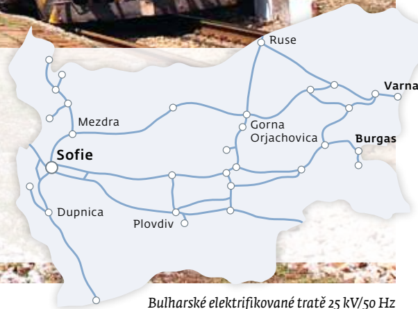
Bulharské elektrifikované tratě 25 kV/50 Hz
